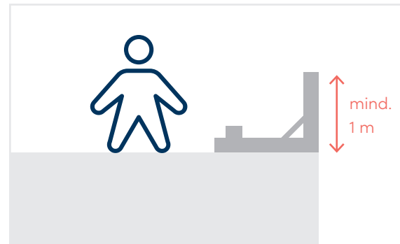
Valbeveiliging vb. met tijdelijke hekwerken
